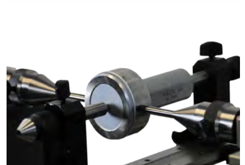
직경 100mm, 길이 280mm 대형 나사 링 게이지 교정 및 측정 (TULM6/L05, LABC-15)
