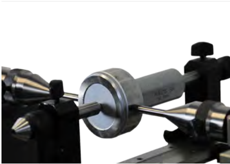
직경 100mm, 길이 280mm 대형 나사 링 게이지 교정 및 측정 (TULM6/L05, LABC-15)
