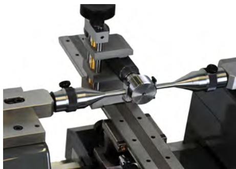
직경 100mm, 길이 280mm 대형 나사 링 게이지 교정 및 측정 (TEL6, TA-SE-30x, LABC-15)
