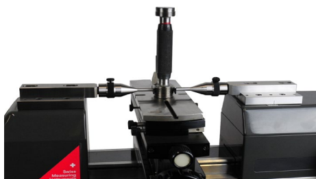
나사 플러그 게이지 교정 및 측정 (TA-SU-313, TEL6, TA-SE-30x)
