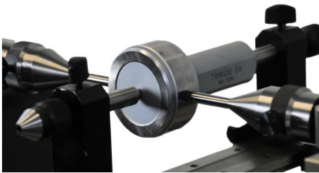
직경 100mm, 길이 280mm 대형 나사 링 게이지 교정 및 측정 (TULM6/L05, LABC-15)
