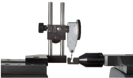
테스트 인디게이터 교정 및 측정 (TULM15)
