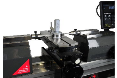
직경 100mm, 길이 280mm 대형 나사 링 게이지 교정 및 측정 (TA-SU-313, TULM6/L05, LABC-15)
