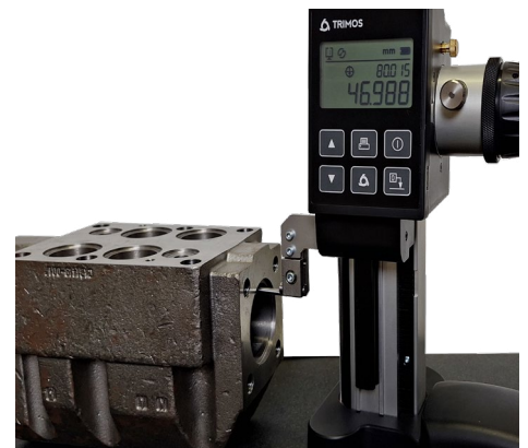
양방향 측정을 통한 내경 측정(V1+)
