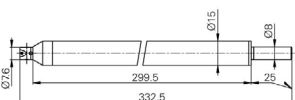
TA-IH-102 프로브 홀더, M2.5, 길이 L=300 mm 612 11 046 Measuring insert holder M2.5, L=300 mm
