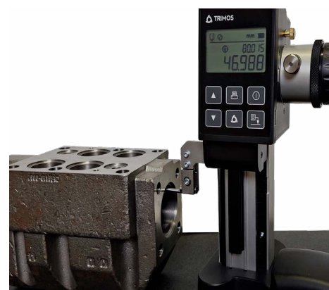
양방향 측정을 통한 내경 측정(V1+)
