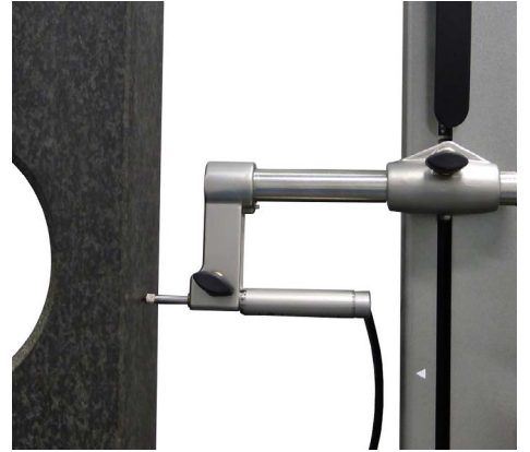
전자 프로브를 이용한 직각도 측정 (V6)
